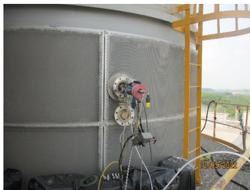
ภาพที่ 3.2-1 แสดงการตรวจวัดคุณภาพอากาศจากปล่องระบาย ในวันที่ 12 มีนาคม พ.ศ. 2565
