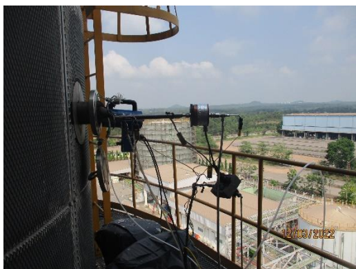
ภาพที่ 3.2-1 แสดงการตรวจวัดคุณภาพอากาศจากปล่องระบาย ในวันที่ 12 มีนาคม พ.ศ. 2565
